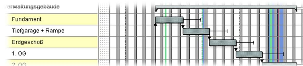
Erstellen Sie nach diesem Schema einen Bauablaufplan, der z.B. nach Bauabschnitten strukturiert wird und die Gewerke nach Geschossen unterschieden werden.
