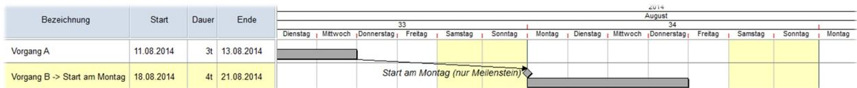
Sollte *Vorgang A* länger brauchen wird *Vorgang B* bei der Berechnung automatisch durch den *Meilenstein* auf den nächsten Montag verschoben.
